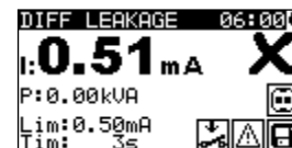
Figuur 5. 29: Voorbeelden meetresultaat verschil-lekstroom
