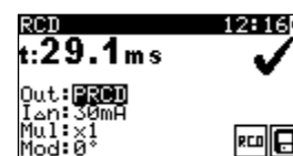
Figuur 5. 37: Voorbeelden van (P)RCD enkelvoudige testresultaten
