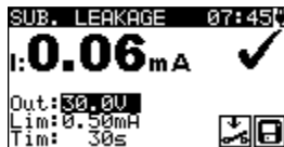
Figuur 5. 19: Voorbeeld van meetresultaten vervangende lekstroom
