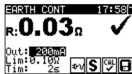
Figuur 5. 7: Voorbeelden van de meetresultaten van de weerstand beschermingsleiding
