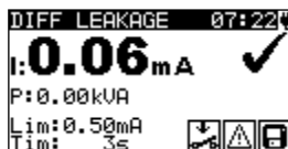
Figuur 5. 29: Voorbeelden meetresultaat verschil-lekstroom
