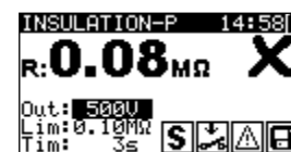
Figuur 5.15: Voorbeeld van isolatieweerstand (S) meetresultaten
