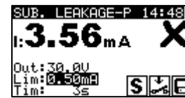
Figuur 5. 23: Voorbeeld meetresultaten van vervangende lekstroom - S
