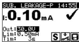
Figuur 5. 23: Voorbeeld meetresultaten van vervangende lekstroom - S
