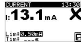
Figuur 5. 45: Voorbeelden meetresultaat stroomtang meting
