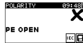
Figuur 5. 26: Voorbeelden resultaat van polariteit test
