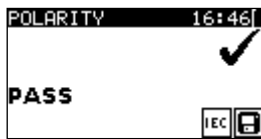
Figuur 5. 26: Voorbeelden resultaat van polariteit test
