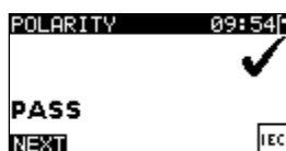
Figuur 6. 44: resultaat scherm polariteit test
