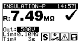
Figuur 5.15: Voorbeeld van isolatieweerstand (S) meetresultaten
