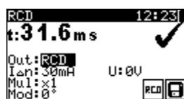
Figuur 5. 37: Voorbeelden van (P)RCD enkelvoudige testresultaten
