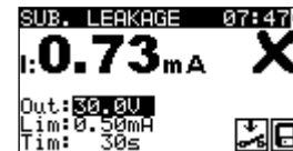
Figuur 5. 19: Voorbeeld van meetresultaten vervangende lekstroom
