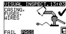
Figuur 5. 3: Visueel inspectiemenu
