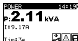
Figuur 5. 40: Voorbeeld meetresultaat vermogenstest
