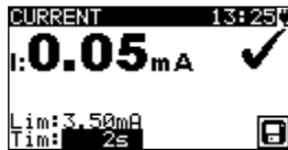
Figuur 5. 45: Voorbeelden meetresultaat stroomtang meting
