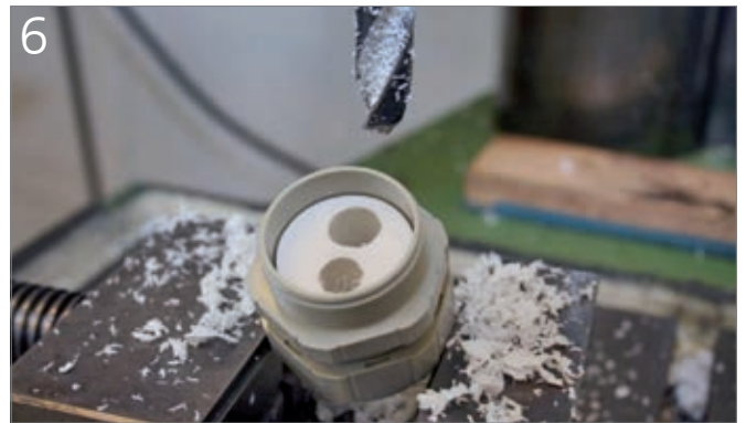
6 Zweite Bohrung in der Ansicht von unten
