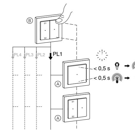
(A) Elektronik-Schalt-Einsatz in PL-Linie 1
