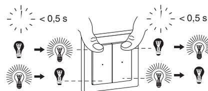
**Вызов сцен освещения (1-позиционный механизм)**
