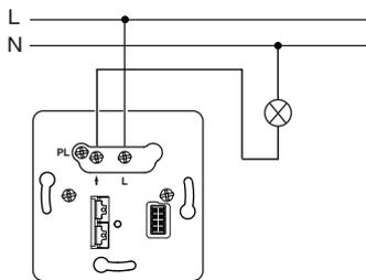
**Два механизма соединены параллельно**
