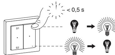
**Включение/выключение нагрузок (2-позиционный механизм)**
