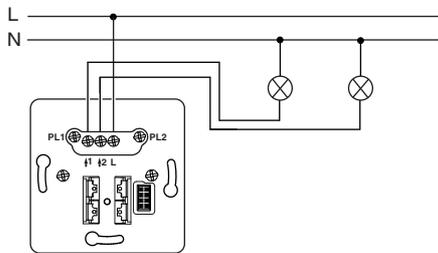
**Механизм с механическими кнопками через PlusLink**
