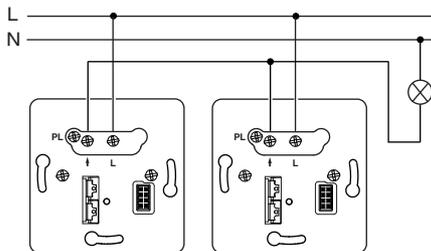
**Механизм с механической кнопкой через PlusLink**
