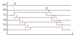
Um botão de ligar (MA) autoriza a ativação do primeiro elemento de aquecimento (S1). Após um atraso de T, o segundo elemento (S2) é iniciado. Após o mesmo atraso, o terceiro elemento é inicializado (S3), em seguida o quarto elemento (S4) novamente após o atraso T. Um botão de desligar (SR) desativa o (S1). Os outros três elementos são progressivamente desativados após o atraso de T.
