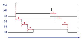
Um botão de ligar (MA) autoriza a ativação do primeiro elemento de aquecimento (S1). Após um atraso de T, o segundo elemento (S2) é inicializado. Após o mesmo atraso, o terceiro elemento é inicializado (S3), em seguida o quarto elemento (S4) novamente após o atraso de T. Um botão de desligar (AR) desativa o S1. Os outros três elementos são progressivamente desativados após o atraso de T.
