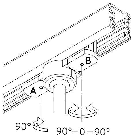
Drehriegel **A** um 90° im Uhrzeigersinn drehen, um den Adapter an die neutrale Phase 0 anzuschließen.
