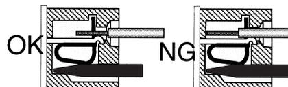
**2.** Si le diamètre externe  $D$  du câble est supérieur à 3,2 mm, il peut être difficile d'utiliser le double câblage.
