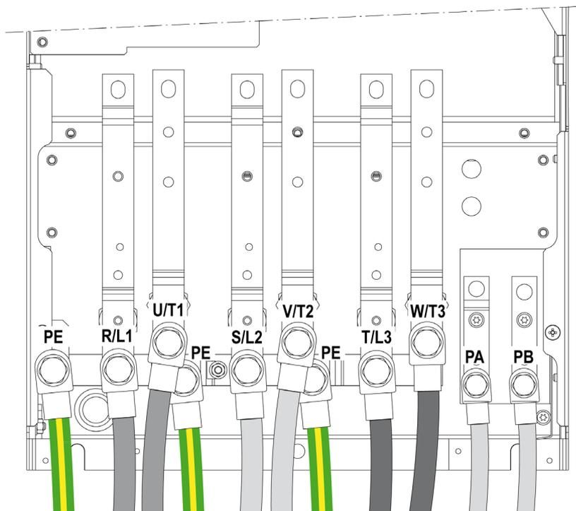
PA/+ 和 PB 端子用于连接制动电阻器。请参考制动电阻器说明书 [NHA87388](#)，可从 [www.schneider-electric.com](http://www.schneider-electric.com) 上获取。
