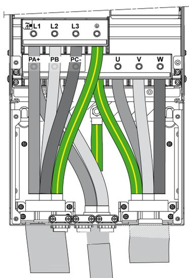
PA/+ 和 PB 端子用于连接制动电阻器。请参考制动电阻器说明书 [NHA87388](#)，可从 [www.schneider-electric.com](http://www.schneider-electric.com) 上获取。
