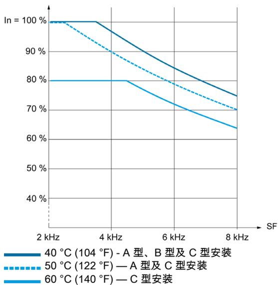
**机架尺寸 7A — 380...480 V - 220 kW**
