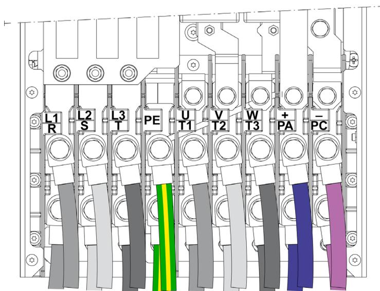
PA/+ 和 PC/- 端子用于连接制动电阻器。请参考制动电阻器说明书 [NVE16635](#)，可从 [www.schneider-electric.com](http://www.schneider-electric.com) 上获取。
