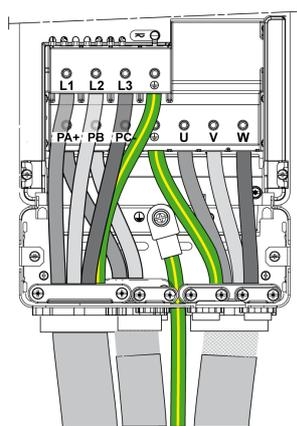
PA/+ 和 PB 端子用于连接制动电阻器。请参考制动电阻器说明书 [NHA87388](#)，可从 [www.schneider-electric.com](http://www.schneider-electric.com) 上获取。
