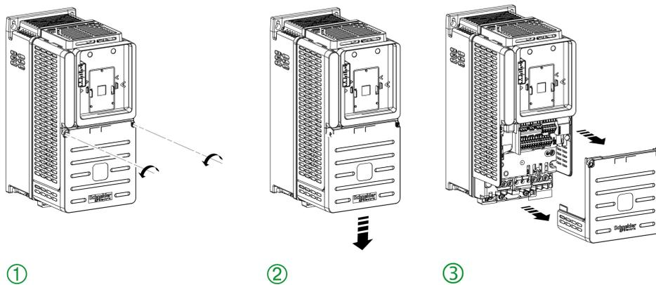
按照下列说明接入机架尺寸为 1 到 3 的 IP20 变频器上的端子
