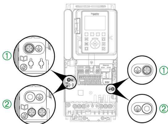
机架尺寸为 3 和 IP55 型机架尺寸为 A 的产品的设置
