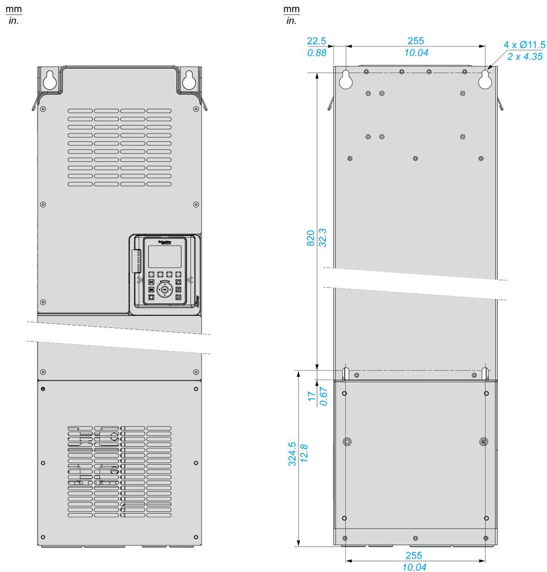
**注意：** 下方导线接线盒 [VW3A9704](#) 单独销售。此零件可将产品安装在墙上。它可保持底部达到 IP21 防护等级和 UL 类型 1 防护等级。
