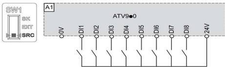
将开关设置到 SK (漏型) 位置
