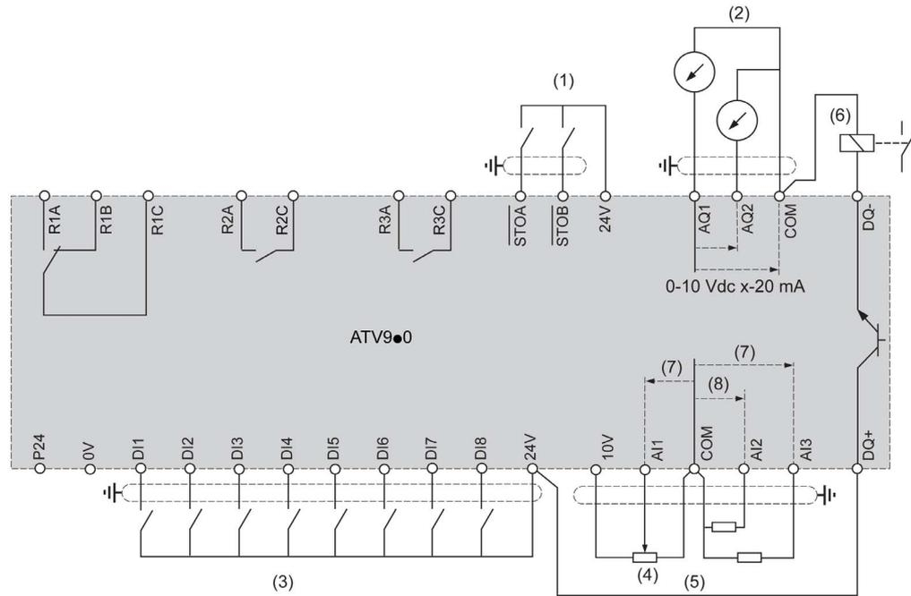
(1) STO 安全扭矩关闭, (2) 模拟输出, (3) 数字输入 - “电磁兼容”章节 (参见第 172 页)中提供的屏蔽说明 (4) 参考电位计 (如SZ1RV1002), (5) 模拟输入, (6) 数字输出, (7) 0-10 Vdc、x-20 mA, (8) 0-10 Vdc、-10 Vdc...+10 Vdc。
