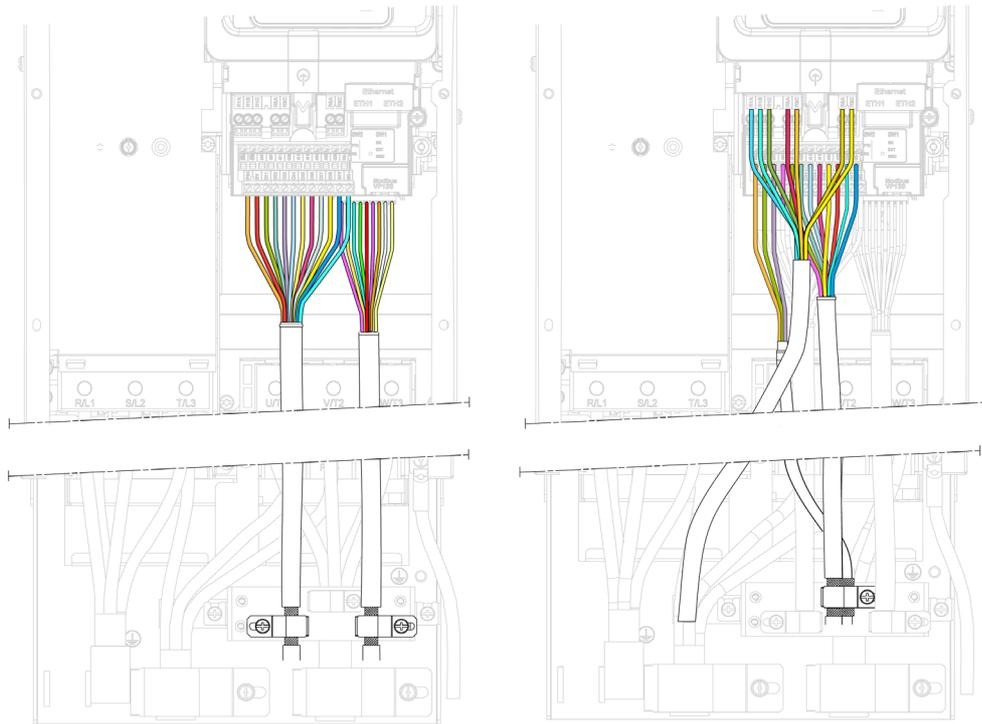
示例：使用 500-690 V 电源电压的机架尺寸 5Y 的电缆径迹
