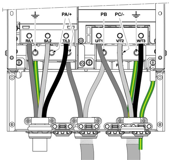
PA/+ 和 PB 端子用于连接制动电阻器。请参考制动电阻器说明书 [NHA87388](#)，可从 [www.schneider-electric.com](http://www.schneider-electric.com) 上获取。
