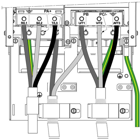
PA/+ 和 PB 端子用于连接制动电阻器。请参考制动电阻器说明书 [NHA87388](#)，可从 [www.schneider-electric.com](http://www.schneider-electric.com) 上获取。
