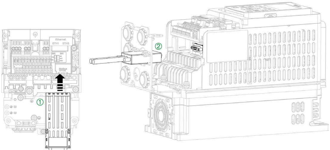
为帮助确保对控制部分正确接线，请遵循以下操作说明来在机架尺寸为 1 的变频器上安装 PROFIBUS 现场总线模块。
