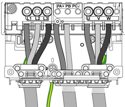
PA/+ 和 PB 端子用于连接制动电阻器。请参考制动电阻器说明书 [NHA87388](#)，可从 [www.schneider-electric.com](http://www.schneider-electric.com) 上获取。
