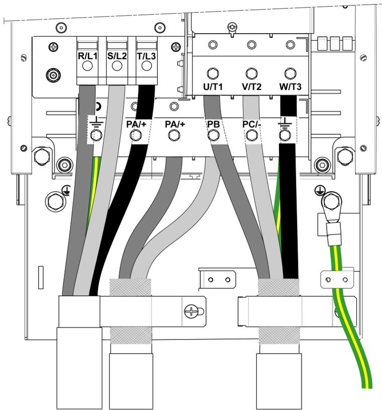
PA/+ 和 PB 端子用于连接制动电阻器。请参考制动电阻器说明书 [NHA87388](#)，可从 [www.schneider-electric.com](http://www.schneider-electric.com) 上获取。
