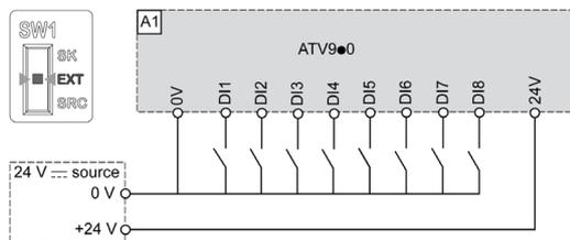
将开关设置到 **EXT** (外部漏型) 位置且在数字输入上进行功能隔离。此配置需要使用 2 个外部电源。
