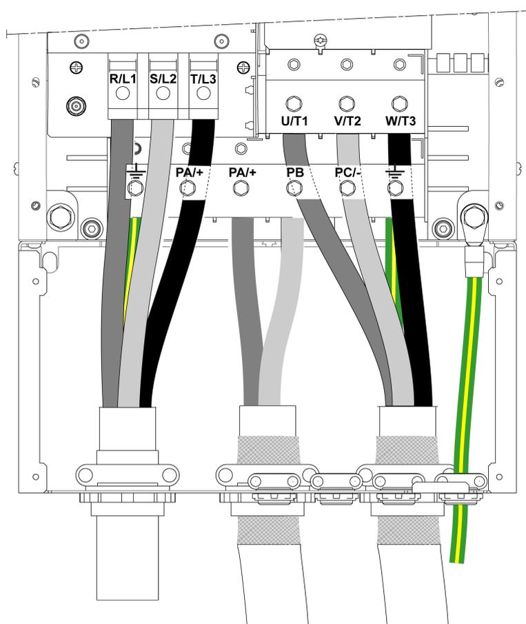
PA/+ 和 PB 端子用于连接制动电阻器。请参考制动电阻器说明书 [NHA87388](#)，可从 [www.schneider-electric.com](http://www.schneider-electric.com) 上获取。
