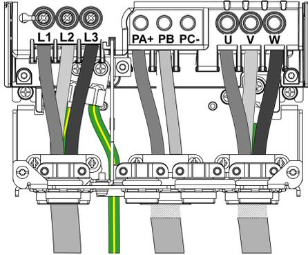
PA/+ 和 PB 端子用于连接制动电阻器。请参考制动电阻器说明书 [NHA87388](#)，可从 [www.schneider-electric.com](http://www.schneider-electric.com) 上获取。
