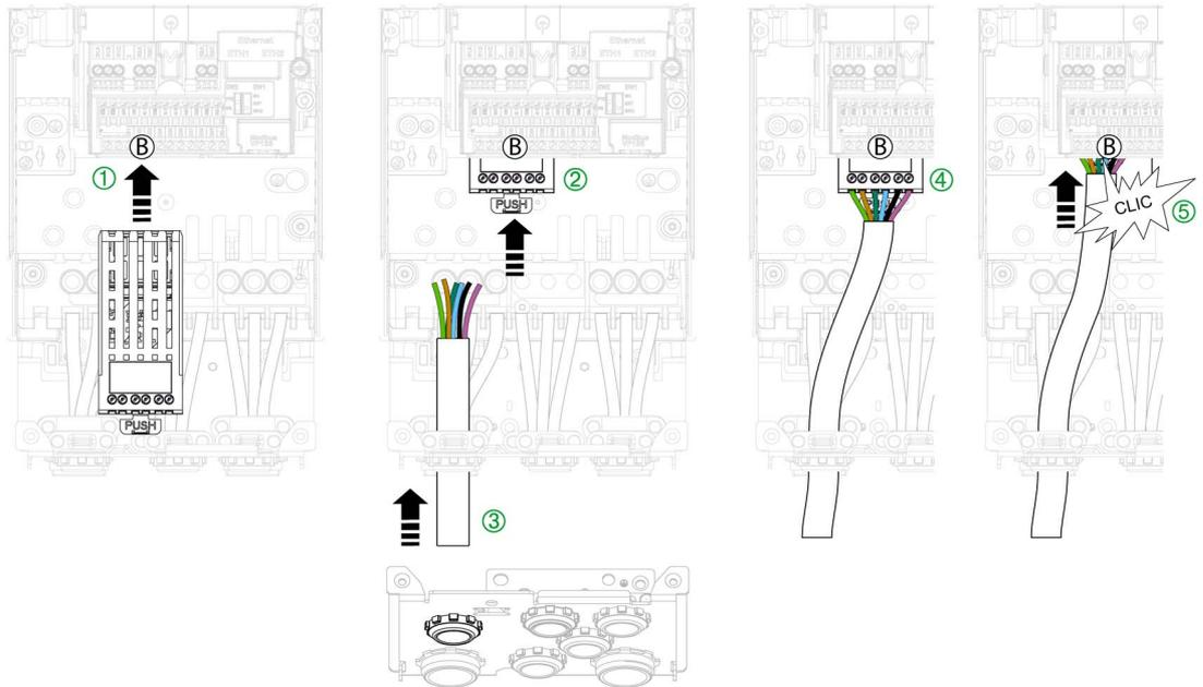
**注意：**图中所示的接线板适用于机架尺寸 2。其他接线板与此接线板稍有不同。
