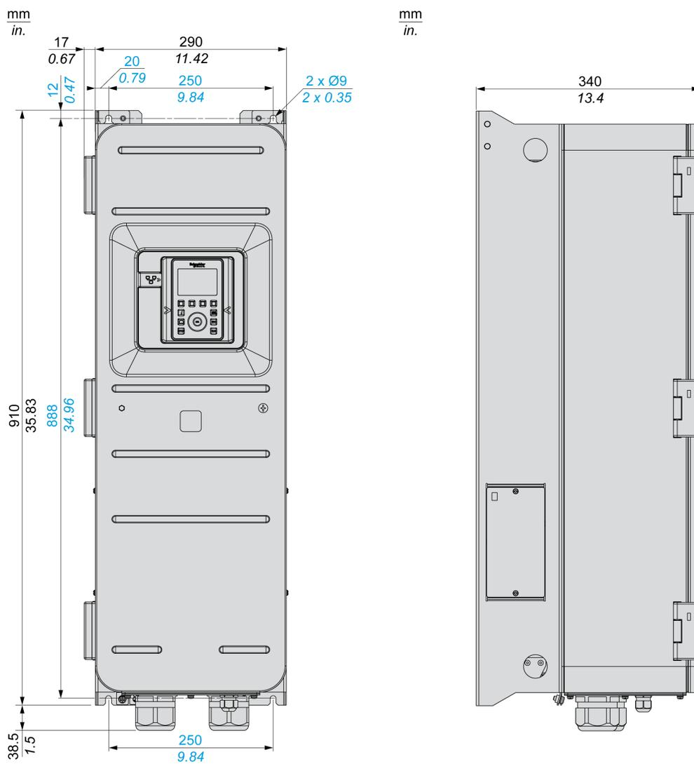
带有隔离开关的 IP55 / UL 类型 1 变频器 — 前视图与侧视图
