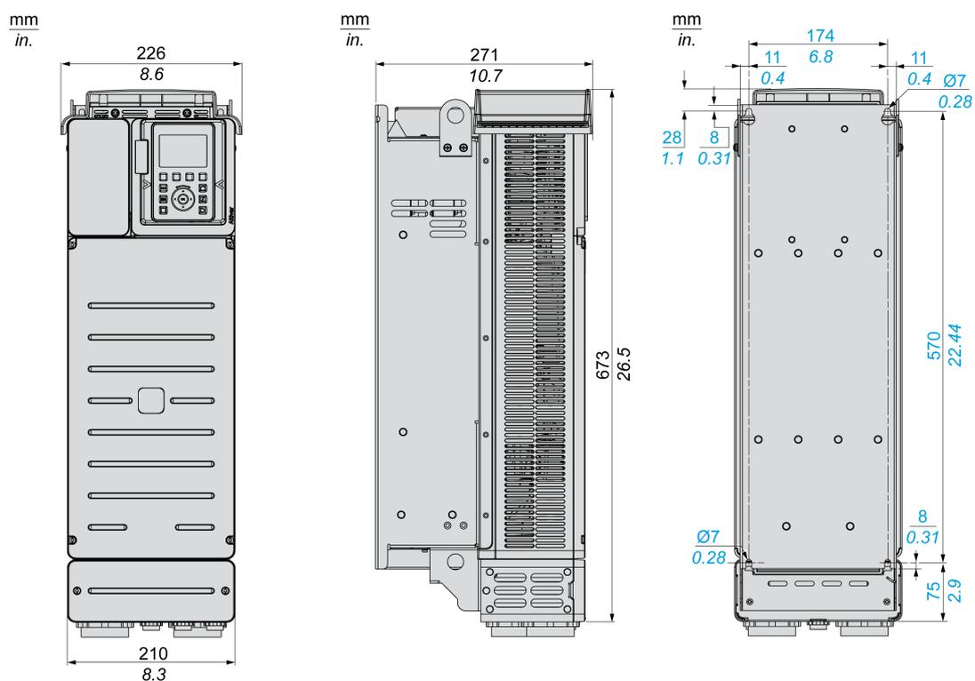
IP20 变频器，底部 (IP00) 除外 - 前视图、侧视图与后视图
