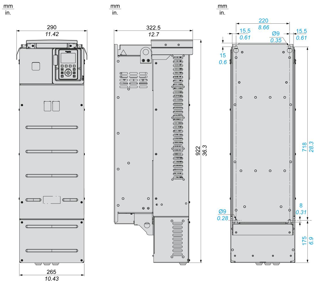
IP20 变频器，底部 (IP00) 除外 - 前视图、侧视图与后视图
