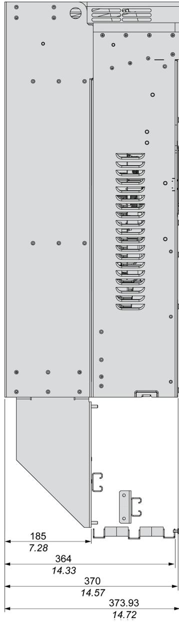
顶部为 IP21 变频器，底部为 IP20 变频器 / UL 类型 1 变频器 - 侧视图和前视图
