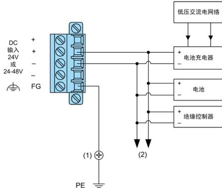
(1) 机架的接地螺钉
