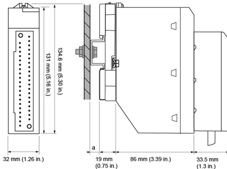
**a** DIN 导轨深度：其值取决于平台中使用的 DIN 导轨类型。请参阅 [安装机架](#) (参见第 36 页)。
