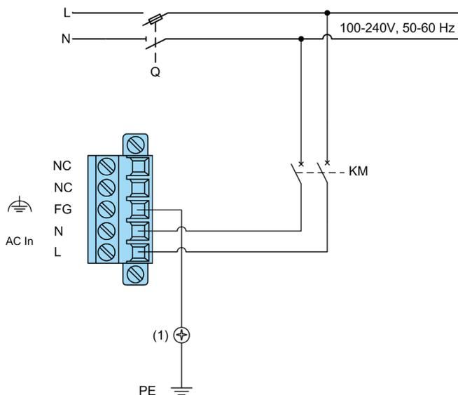
(1) 机架的接地螺钉
