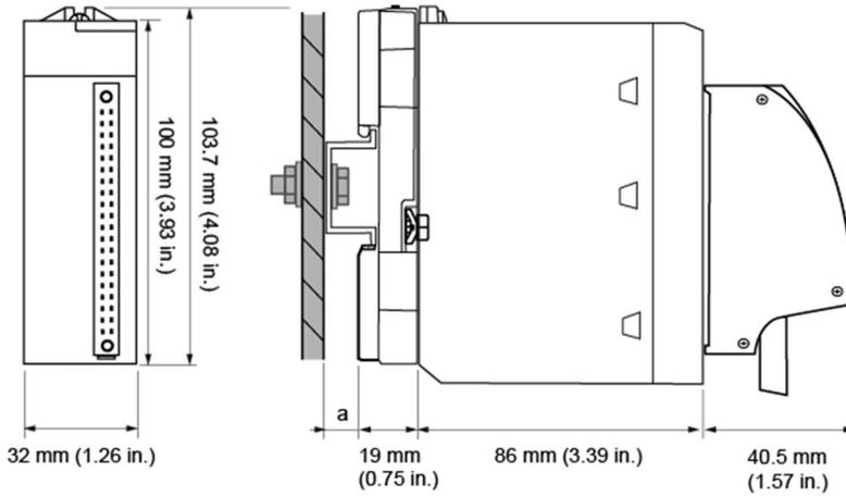
a DIN 导轨深度：其值取决于平台中使用的 DIN 导轨类型。
