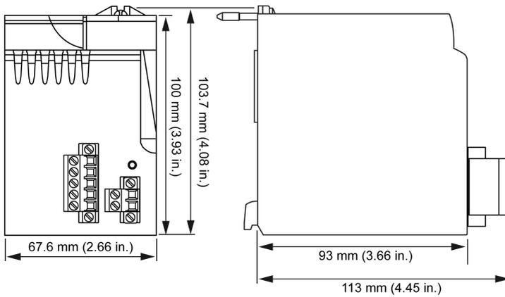
下图显示了冗余电源模块的尺寸：
