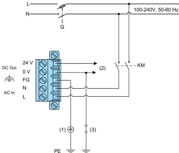
(1) 机架的接地螺钉
