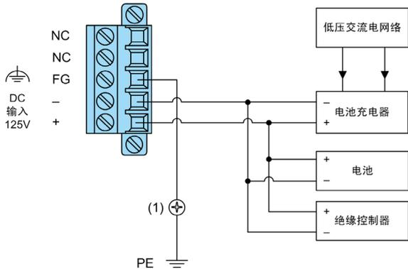
(1) 机架的接地螺钉
