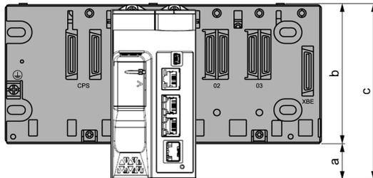
**a** 机架下方的额外空间用于容纳 CPU 的高度。
