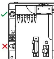
**注意：** 右侧两个螺钉可以一直供您使用，直至没有机架扩展模块被安装。
