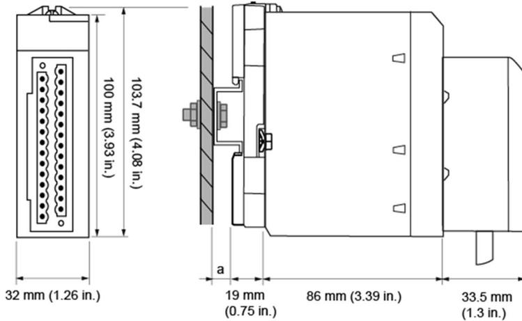
a DIN 导轨深度：其值取决于平台中使用的 DIN 导轨类型。
