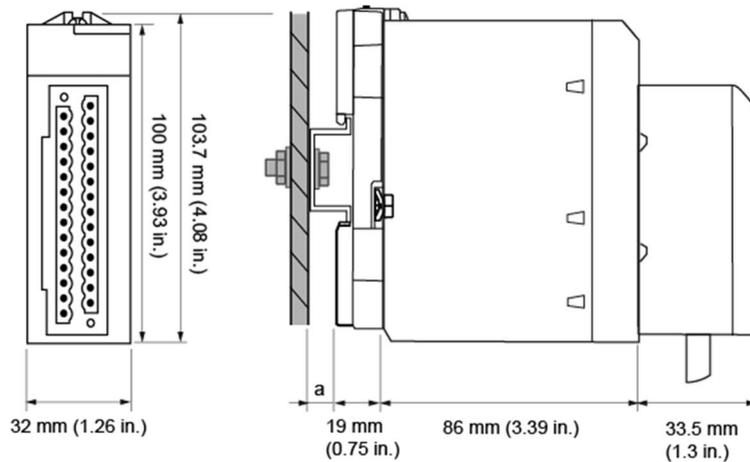
**a** DIN 导轨深度：其值取决于平台中使用的 DIN 导轨类型。请参阅 [安装机架](#) (参见第 36 页)。
