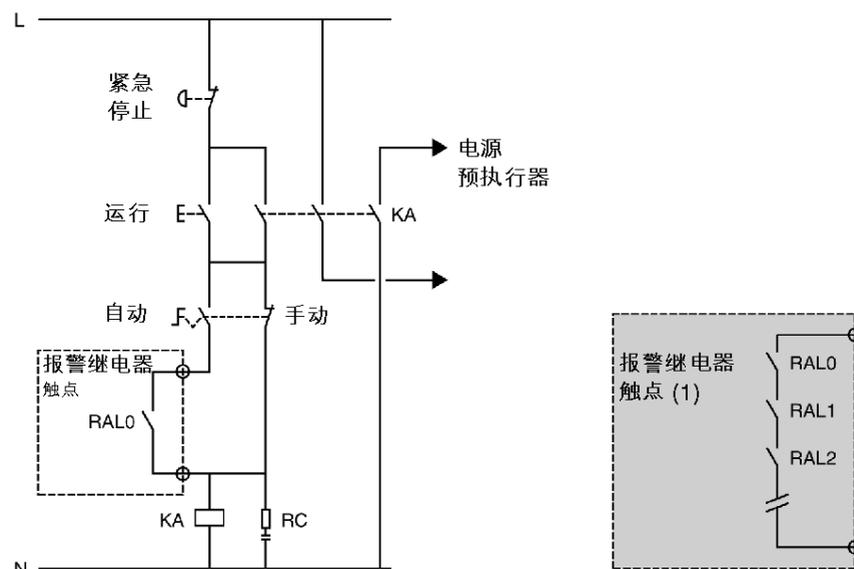
KA : 由自动运行模式下的电源模块中的报警继电器所控制的触点。
