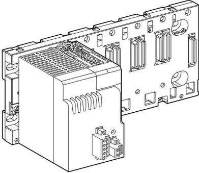
**注意：** 电源模块设计只允许将它安装在专用插槽中。
