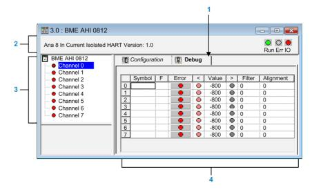
The output module Debug tab:
