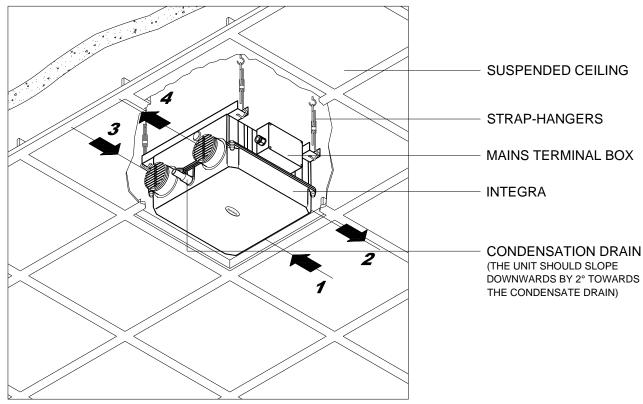
Fig. 1b. SUSPENDED IN ROOF VOID
