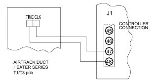
FIG 26: HEATER INTERLOCK CONNECTION
