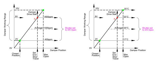
FIG 29A PROPORTIONAL DAMPER CO<sub>2</sub> OPERATION
