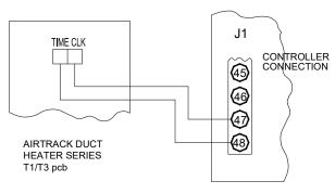
FIG 26: HEATER INTERLOCK CONNECTION
