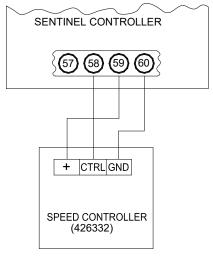
FIG 21: REMOTE SPEED CONTROL CONNECTION TO SENTINEL CONTROLLER
