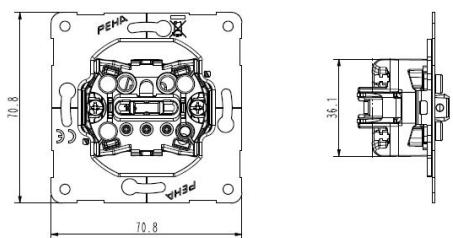
**Wechselschalter mit Orientierungslicht
