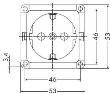
**Compacta Schuko Steckdose SCHUKO Einbau
