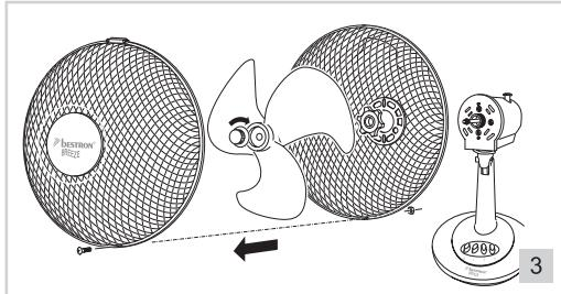
Om de ventilator weer in elkaar te zetten, plaatst u de losse onderdelen terug op de ventilator, zoals beschreven onder 'Ventilator monteren'.
