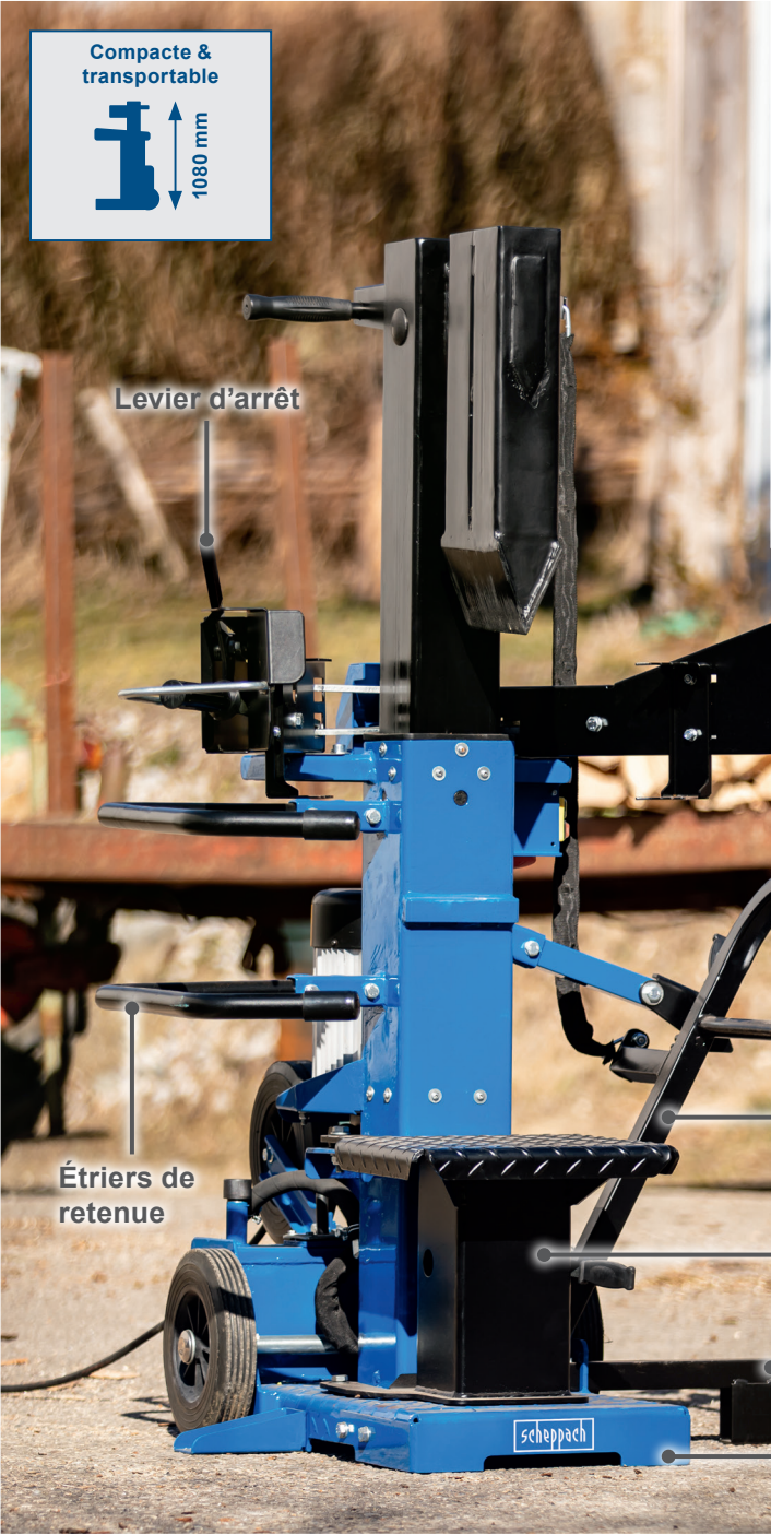
La conception compacte rend le fendeur peu encombrant et facile à transporter
