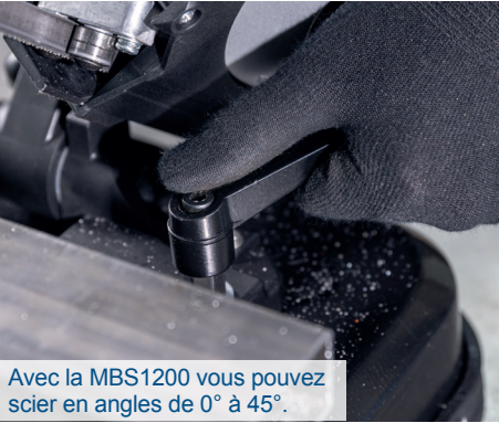
Les guides-lames à roulement à billes assurent des coupes de précision.
