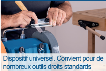
Le positionneur d'angle permet d'avoir toujours le bon angle d'affûtage des outils
