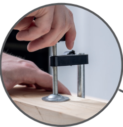
Dispositif de maintien pour garantir la fixation des pièces pendant le sciage
