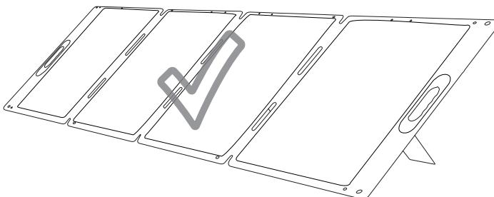
2. Si desea o necesita (condiciones climáticas ventosas, por ejemplo) reparar el producto, use los ojales ubicados en cada esquina para mantener el panel en su lugar y evitar que se pierda o se dañe.
