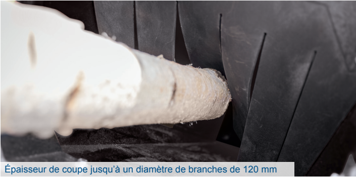
Épaisseur de coupe jusqu'à un diamètre de branches de 120 mm
