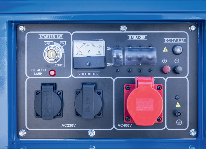
Voltmètre intégré, avertissement de niveau d'huile (protège le moteur contre le fonctionnement à sec) et protection contre les surcharges (assure la sécurité de l'appareil).
