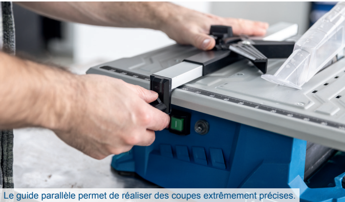
Le guide parallèle permet de réaliser des coupes extrêmement précises.
