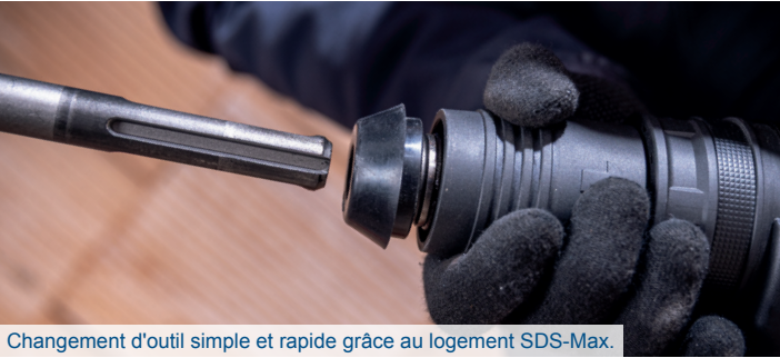
Changement d'outil simple et rapide grâce au logement SDS-Max.
