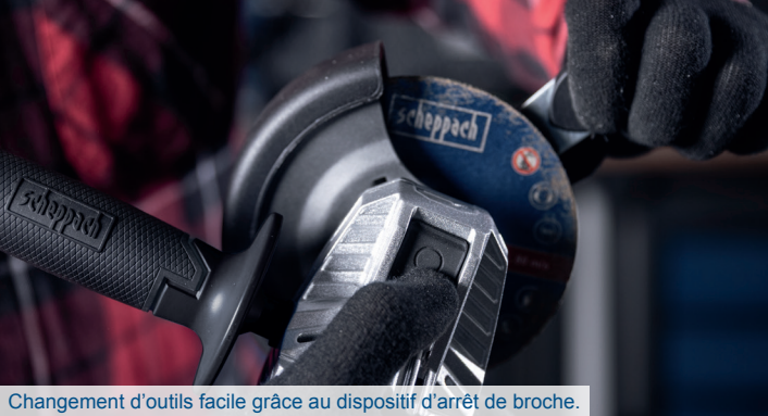
Changement d'outils facile grâce au dispositif d'arrêt de broche.
