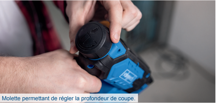
Molette permettant de régler la profondeur de coupe.
