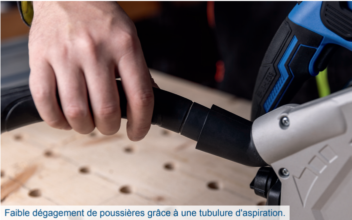
Faible dégagement de poussières grâce à une tubulure d'aspiration.
