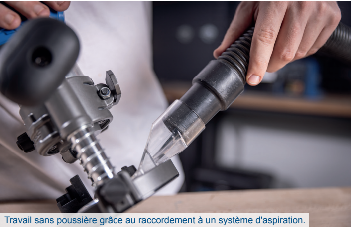
Travail sans poussière grâce au raccordement à un système d'aspiration.
