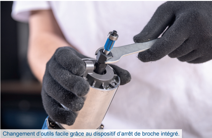
Changement d'outils facile grâce au dispositif d'arrêt de broche intégré.
