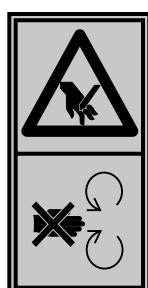
Attention – lames en rotation. Ne pas mettre les doigts, mains ou pieds dans les ouvertures quand la machine est en marche.
