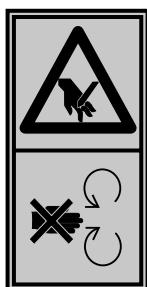
**NEBEZPEČÍ** - Rotační kotouč. Udržujte horní i dolní končetiny v dostatečné vzdálenosti od otvorů stroje, když stroj pracuje!
