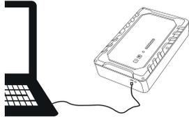
El STARTRONIC se puede recarga mediante su puerto micro USB (2) con todos los aparatos electrónicos que posean un puerto USB 5V 2A. El cable de carga USB no está incluido. La recarga completa del aparato durará alrededor de 15 minutos.
