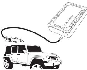
über das Zigarettenanzünderanschlusskabel (8) an einem anderen Fahrzeug. Schließen Sie es über den Eingangsport des Startronic an um den Ladevorgang zu starten. Eine Komplettladung benötigt bis zu 2 Minuten.
