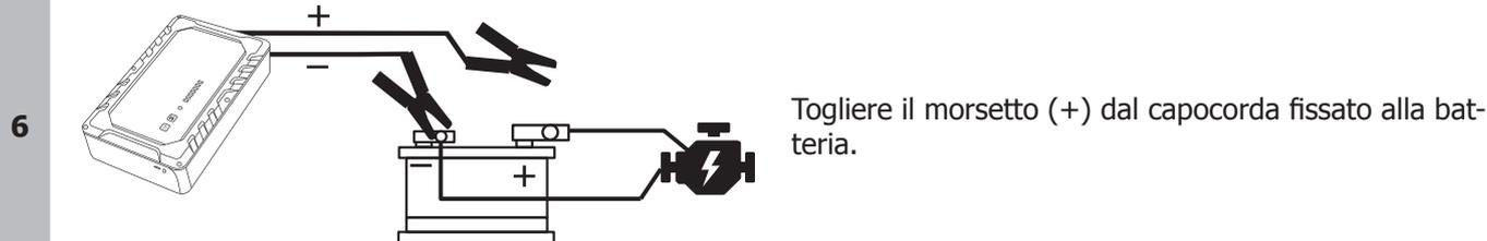
**MODO GLOW: PRERISCALDAMENTO MOTORE DIESEL**
