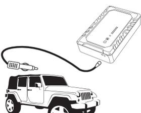
Подключите автомобильный переходник (8) к прикуривателю машины. Чтобы начать зарядку подключите другой конец переходника к входному разъему (3) аппарата STARTRONIC. Полная зарядка продлится около 2 минут.
