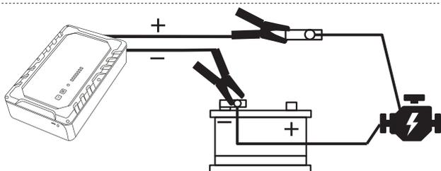
Entfernen Sie den (+)-Anschluß an der Batterie und verbinden Sie die rote Klemme des Startronics mit dem zuvor entfernten Anschlußkabel. Verbinden Sie jetzt schwarze Klemme des Startronic mit dem (-)-Pol der Batterie.
