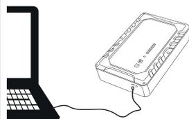
Lo STARTRONIC potrebbe essere ricaricato grazie alla porta micro USB (2) con tutti i dispositivi elettronici con una porta USA 5V 2A. Il cavo di carica USB non è fornito. La ricarica completa del dispositivo durerà circa 15 minuti.
