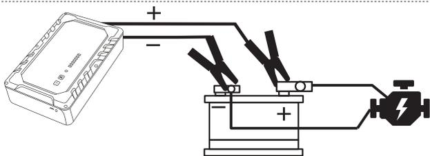
Montieren Sie jetzt den (+)-Anschluß wieder gemeinsam mit der roten Klemme des Startronic am (+)-Pol der Batterie.
