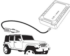
Branchez l'adaptateur voiture (8) sur la prise allume cigare d'un véhicule. Branchez au port d'entrée (3) du STARTRONIC l'autre extrémité de l'adaptateur pour démarrer la charge (*La recharge complète de l'appareil prendra environ 2 minutes*).
