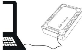
Le STARTRONIC peut être rechargé grâce à son port micro USB (2) avec tous les appareils électroniques équipés d'un port USB 5V 2A. Le câble de charge USB n'est pas fourni (*La recharge complète de l'appareil prendra environ 15 minutes*).
