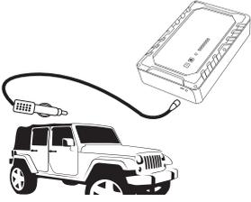
Conecte el adaptador de vehículo (8) sobre la toma del encendedor de este. Conecte al puerto de entrada (3) del STARTRONIC la otra extremidad del adaptador para iniciar la carga. La recarga completa del aparato dura alrededor de 2 minutos.
