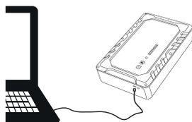
über den Mikro-USB-Port (2). Sie können den Port an Geräten anschliessen, die mit einem 5V/2A-USBPort ausgestattet sind. Das USB-Ladekabel ist nicht im Lieferumfang enthalten. Eine Komplettladung über USB benötigt bis zu 15 Minuten.
