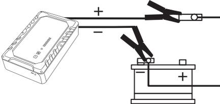
Desconecte el terminal (+) de su batería y conecte la pinza roja (+) del STARTRONIC sobre esta. Conecte la pinza negra (-) sobre el terminal (-) de su batería.
