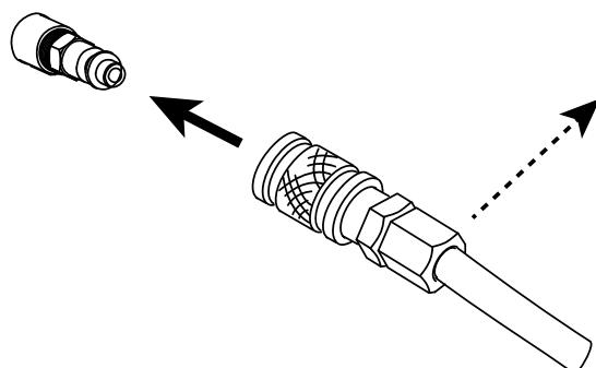
Conecte el suministro de gas al generador mediante un conducto de gas inerte de un diámetro interno de 9,5 mm y un acople rápido.
