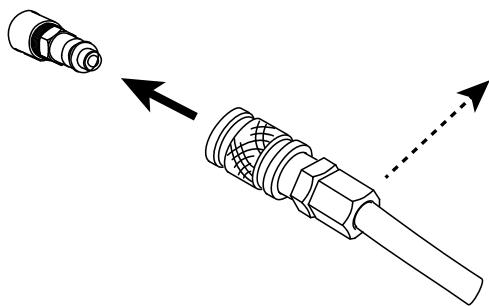
Подсоедините подачу газа к источнику тока с помощью шланга для инертного газа внутреннего диаметра 9,5 мм и быстроразъемного соединителя.
