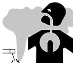
Rook, gassen en stof uitgestoten tijdens het snijden zijn gevaarlijk voor de gezondheid. Zorg voor voldoende ventilatie, soms is toevoer van verse lucht tijdens het lassen noodzakelijk. Een lashelm met verse luchtaanvoer kan een oplossing zijn als er onvoldoende ventilatie is.
