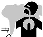
El humo, el gas y el polvo que se emite durante el corte son peligrosos para la salud. Hay que prever una ventilación suficiente y en ocasiones puede ser necesario un aporte de aire. Una máscara de aire puede ser una solución en caso de aireación insuficiente. Compruebe que la aspiración es eficaz controlándola conforme a las normas de seguridad.
