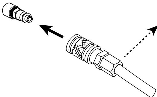
Gasversorgung über einen Inertgasschlauch mit Innendurchmesser 9,5 mm und einer Schnellkupplung an die Stromquelle anschließen.
