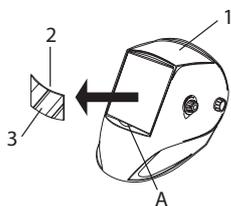
L'écran de garde extérieur (2) est extractible en plaçant un doigt sous l'écran sur le point (A) du masque (1). Lors du changement d'écran, penser à retirer, au préalable, le film protecteur (3). Ce film ne peut être enlevé quand l'écran de garde est déjà en position dans le masque.
