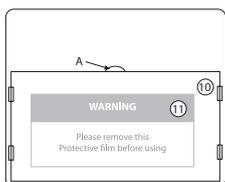
Для смены внутреннего защитного экрана (10), передвиньте его вниз нажимая пальцем на точку (А). Во время замены экрана не забудьте снять заранее защитную пленку (11)
