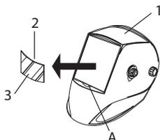
Внешний защитный экран (2) можно вынуть поместив палец в точку (А) под экраном (1). Во время замены экрана не забудьте снять заранее защитную пленку (3). Эту пленку будет невозможно убрать после замены экрана.
