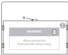
Om het binnenste scherm (10) te vervangen, leg uw vinger op punt A en laat het naar beneden glijden. Als u het scherm vervangt, vergeet niet het beschermfolie (11) van tevoren te verwijderen.
