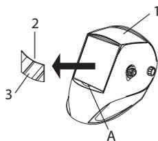
La pantalla protectora exterior (2) se puede extraer poniendo un dedo sobre la pantalla en el punto (A) de la máscara (1). Cuando cambie la pantalla, recuerde retirar antes el film protector (3). Este film protector se puede quitar cuando la pantalla protectora está posicionada en la máscara.
