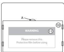
Pour changer l'écran de garde intérieur (10), faites le glisser, vers le bas, en plaçant le doigt sur le point (A.)
