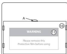
Zum Ersetzen der Innenscheibe (10), lösen Sie diese durch Druck auf Punkt (A). Beim Ersetzen einer Scheibe vorher die Folie (11) entfernen.
