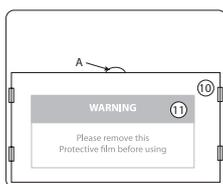
Per sostituire lo schermo protettivo interno (10), fatelo scivolare verso il basso, mettendo il dito sul punto (A). Quando lo sostituite, ricordate prima di togliere la pellicola protettiva (11).
