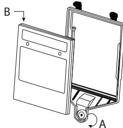
1. Allentare la vite di fissaggio (A)
