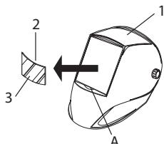
Die Außenscheibe (2) ist durch Druck auf den Punkt (A) des Helmes (1) unter der Scheibe entfernbar.
