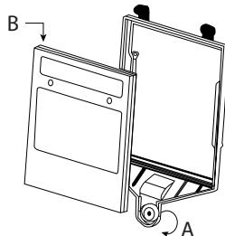
1. Bevestigingsschroef losschroeven (A)
