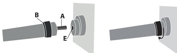
Вставьте коннектор горелки (A) в гнездо (E) и привинтите часть B. Хорошо затяните горелку.
