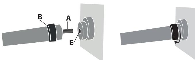
Stecken Sie den Brennerkabelstecker in den Anschluss (E) und schrauben das Teil B fest. Schrauben Sie den Brenner sorgfältig fest. Um den Brenner zu entfernen, schrauben Sie wie oben genannt ab.
