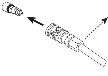
Collegare l'alimentazione gas alla fonte di corrente all'aiuto di un tubo a gas inerte di diametro interno di 9,5 mm e di un commutatore a raccordo rapido.
