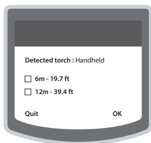
Existen dos tipos de antorchas que el aparato detecta automáticamente:
