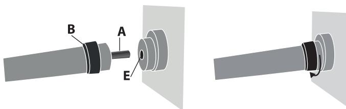
Inserte el conector de la antorcha (A) en el receptor hembra (E) y atornille la parte B. Asegúrese de fijar bien la antorcha.
