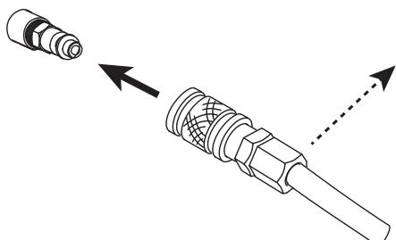
Подсоедините подачу газа к источнику тока с помощью шланга для инертного газа внутреннего диаметра 9,5 мм и быстроразъемного соединителя.
