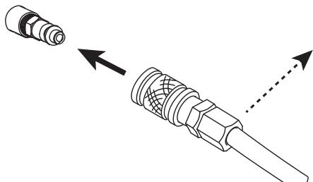
Koppel de gastoever aan aan de voedingsbron met behulp van een gaslang (inert gas) met een binnendiameter van 9,5 mm en een snelkoppling.
