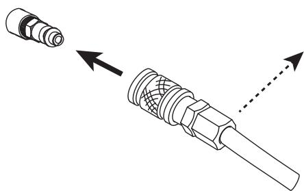
Conecte el suministro de gas al generador mediante un conducto de gas inerte de un diámetro interno de 9,5 mm y un acople rápido.
