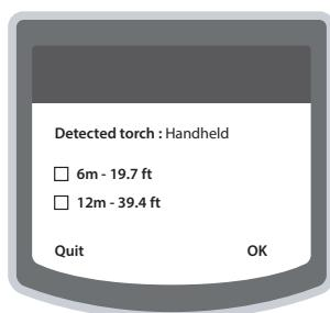
Es gibt 2 Brenner-Typ, die von dem Gerät automatisch erkannt werden:
