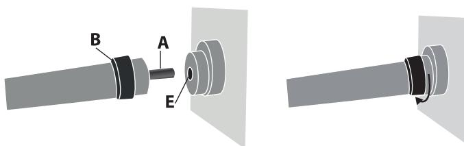
Inserire il connettore della torcia (A) nell'alloggiamento femmina (E) e avvitare la parte B. Attenzione a stringere bene la torcia.
