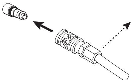
Raccorder l'alimentation en gaz à la source de courant à l'aide d'un tuyau à gaz inerte d'un diamètre interne de 9,5 mm et d'un coupleur à raccord rapide.
