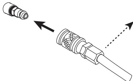
Schließen Sie die Gasversorgung über einen Inertgasschlauch mit einem Innendurchmesser von 9,5 mm und einer Schnellkupplung an.
