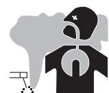
Beim Schweißen entstehen Rauchgase bzw. toxische Dämpfe, die zu Sauerstoffmangel in der Atemluft führen können. Sorgen Sie daher immer für ausreichend Frischluft, technische Belüftung (oder ein zugelassenes Atmungsgerät).
