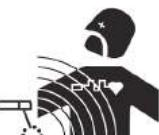
La corrente elettrica passando attraverso a qualunque conduttore prodotto dai campi elettrici e magnetici (EMF) localizzati. La corrente di saldatura produce un campo elettromagnetico attorno al circuito di saldatura e al dispositivo di saldatura.
