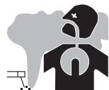
Les fumées, gaz et poussières émis par le soudage sont dangereux pour la santé. Il faut prévoir une ventilation suffisante, un apport d'air est parfois nécessaire. Un masque à air frais peut être une solution en cas d'aération insuffisante.
