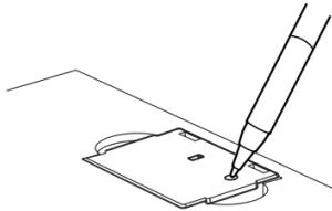
Le voyant lumineux rouge du bouton de configuration clignote brièvement puis s'allume pendant environ cinq secondes pour indiquer que le détecteur 2 est prêt à accepter le signal de configuration. Pendant ces 5 secondes, vous devrez appuyer brièvement sur le bouton test du Détecteur 1 pour interconnecter les deux détecteurs sans fil.
