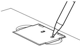
Die rote LED neben der Einlerntaste blinkt kurz auf und leuchtet dann etwa 5 Sekunden, um anzuzeigen, dass der Melder bereit ist, das Einlernsignal eines anderen Melders zu empfangen. In den nächsten 5 Sekunden müssen Sie die Testtaste am Melder 1 kurz drücken, um die Vernetzung der beiden Meldern herzustellen.
