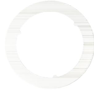
Adapterring für die Montage von Leuchten, die einen Ausschnitt von Ø139mm benötigen, in einem vorhandenen Ausschnitt von Ø175mm. Der Ring hat einen Außendurchmesser von Ø200mm.
