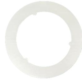
Adapterring für die Montage von Leuchten, die einen Ausschnitt von Ø114mm benötigen, in einen vorhandenen Ausschnitt von Ø150mm. Der Ring hat einen Außendurchmesser von Ø175mm.
