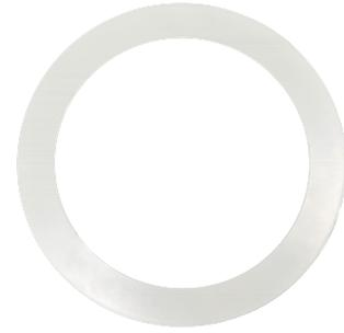
Adapterring für die Montage von Leuchten, die einen Ø173mm Ausschnitt benötigen, in einem bestehenden Ø200mm Ausschnitt. Der Ring hat einen Außendurchmesser von Ø225mm.
