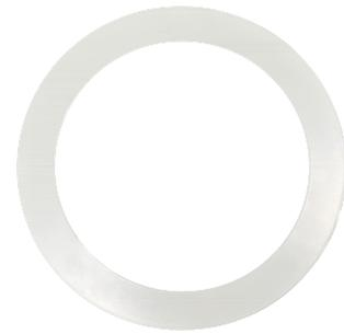
Accessoire de bague d'adaptation pour le montage de luminaires nécessitant une découpe de Ø173mm, dans une découpe existante de Ø200mm. L'anneau a un diamètre extérieur de Ø225mm.
