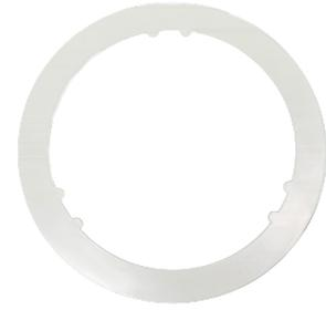
Accessoire de bague d'adaptation pour le montage de luminaires nécessitant une découpe de Ø194mm, dans une découpe existante de Ø225mm. L'anneau a un diamètre extérieur de Ø250mm.
