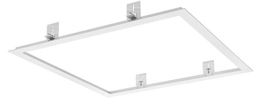
Cadre ed'encastrement plafond, accessoire pour les familles de panneaux, types Sq620. Découpe au plafond : 646 x 646 mm.
