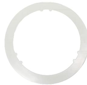
Anello adattatore per il montaggio di apparecchi che richiedono un'apertura di Ø194 mm in un'apertura esistente di Ø225 mm. L'anello ha un diametro esterno di Ø250 mm.
