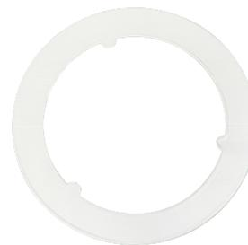
Anello adattatore per il montaggio di apparecchi che richiedono un'apertura di Ø135 mm in un'apertura esistente di Ø175 mm. L'anello ha un diametro esterno di Ø200 mm.
