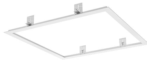
Telaio per installazione a incasso, accessorio per le gamme di pannelli, tipo Sq620. Apertura a soffitto: 646 x 646 mm.
