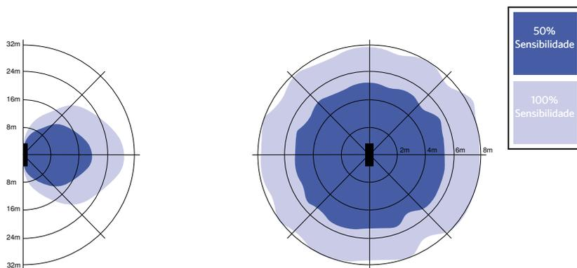
Instalação - Montado na parede
