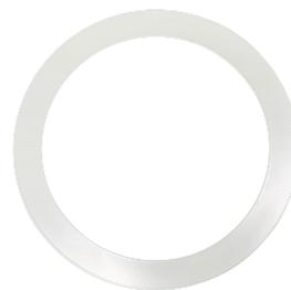
Anello adattatore per il montaggio di apparecchi che richiedono un'apertura di Ø199 mm in un'apertura esistente di Ø225 mm. L'anello ha un diametro esterno di Ø250 mm.
