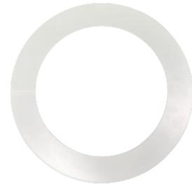
Accessoire de bague d'adaptation pour le montage de luminaires nécessitant une découpe de Ø199mm, dans une découpe existante de Ø220-240mm. L'anneau a un diamètre extérieur de Ø275mm.
