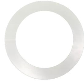
Acessório de anel adaptador para montagem de luminárias que requerem um recorte de Ø199mm, num recorte existente de Ø220-240mm. O anel tem um diâmetro exterior de Ø275mm.
